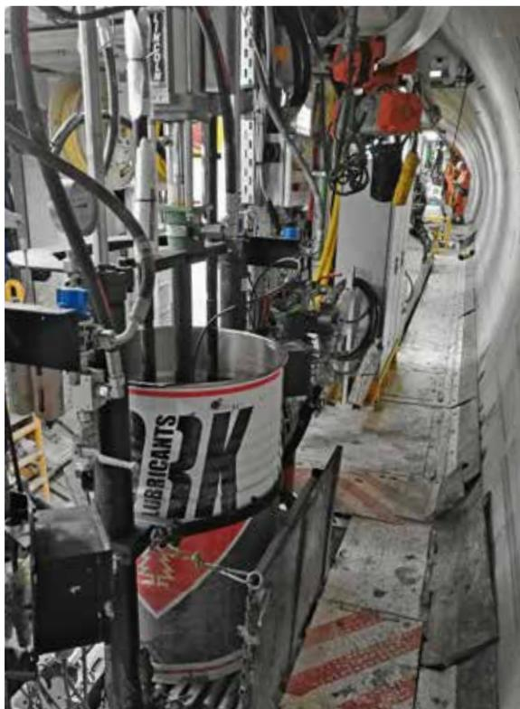
Les lubrifiants biodégradables YORK sont à l'œuvre dans le roulement principal de la tête d'abattage et le système hydraulique.
