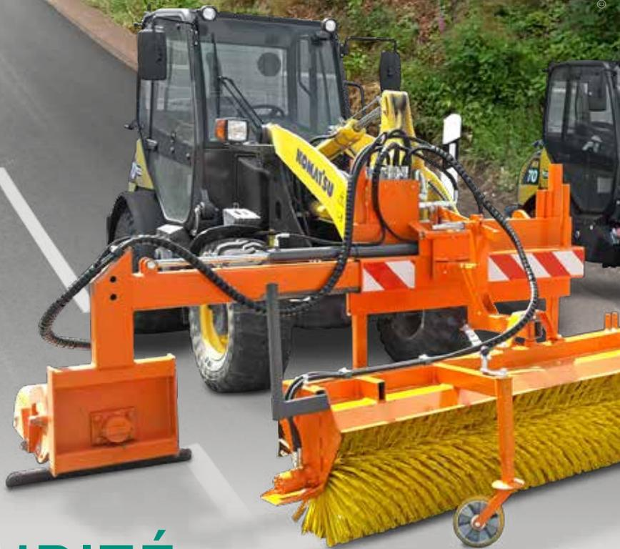
*Un finisseur sert à aménager les accotements à la largeur, la hauteur et l'inclinaison latérale voulues. La réalisation d'accotements, partout en Allemagne, est la spécialité de la société Hohberg GmbH depuis 1990. Les machines nécessaires à l'exécution de ces travaux sont construites par me-group. Une symbiose idéale entre constructeur et utilisateur, qui misent tous deux sur les produits MOTOREX.*
