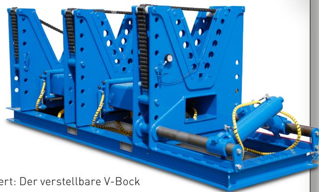
Patentiert: Der verstellbare V-Bock ermöglicht das rutschfeste Einspannen von konischen Objekten.
