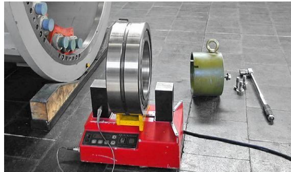
Mit Hilfe eines Induktions-Anwärmegerät werden die neuen Lager montiert.
