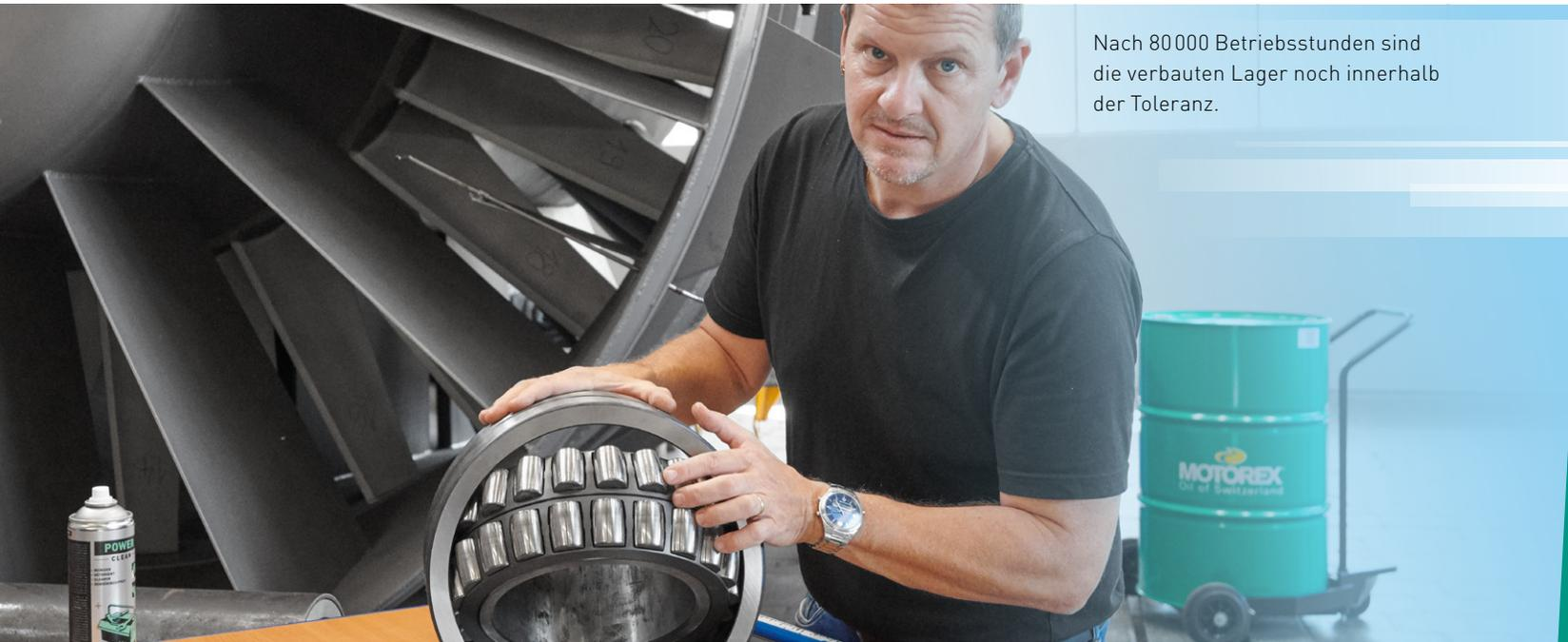
Nach 80 000 Betriebsstunden sind die verbauten Lager noch innerhalb der Toleranz.
