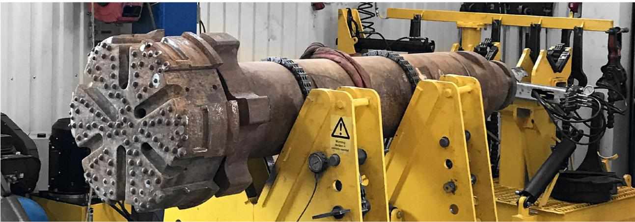
Selbst fest verschraubte Bohrköpfe lassen sich einfach per Knopfdruck lösen.
