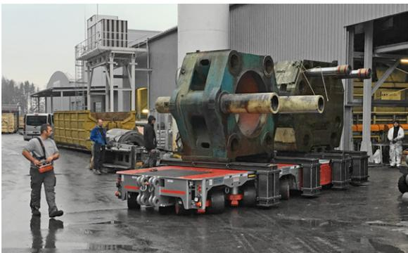
Der selbstfahrende Industrieroller bewegt bis zu 175 Tonnen und wird fernbedient gesteuert.
