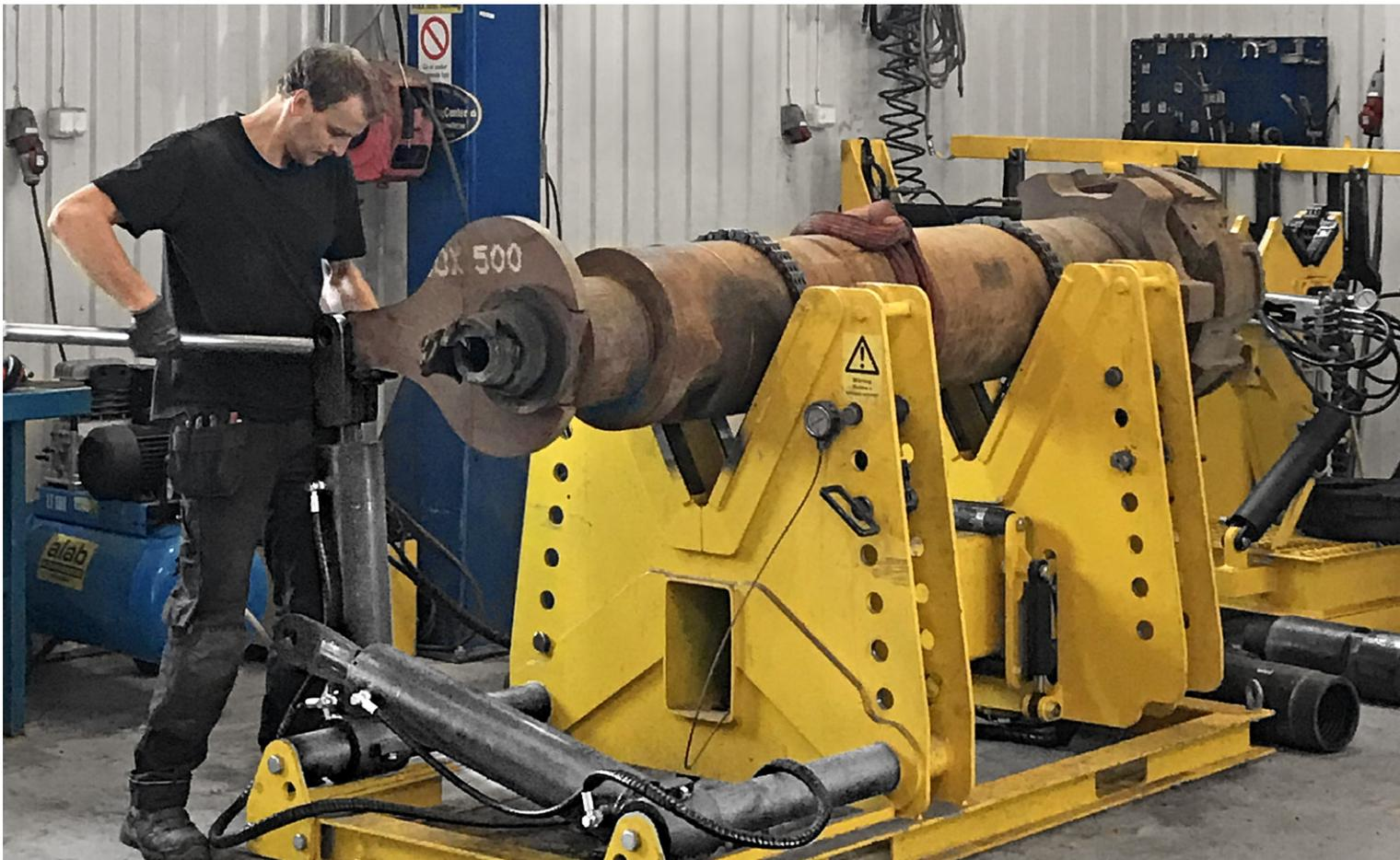
L'huile hydraulique transfère jusqu'à 30 tonnes de puissance au boulonnage pendant le processus de desserrage.
