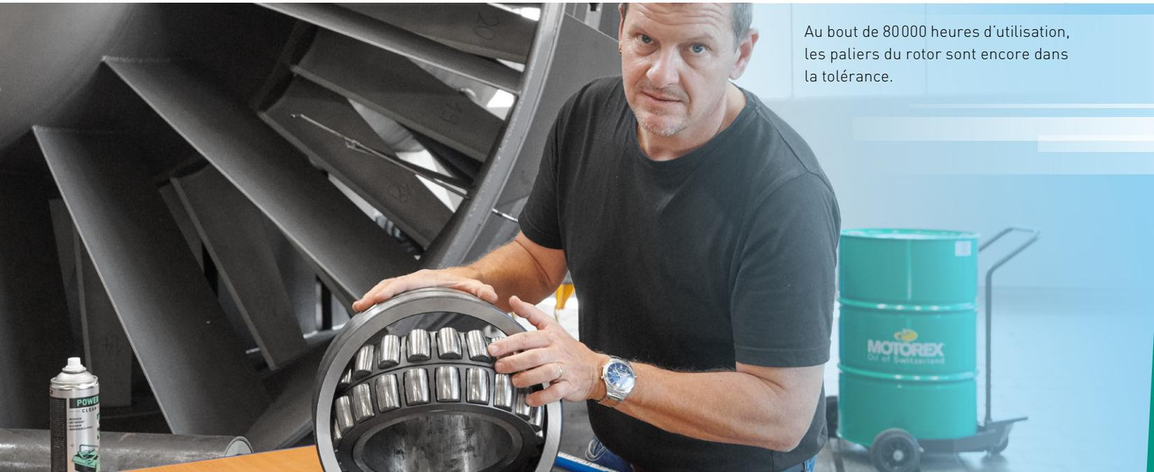
Au bout de 80000 heures d'utilisation, les paliers du rotor sont encore dans la tolérance.
