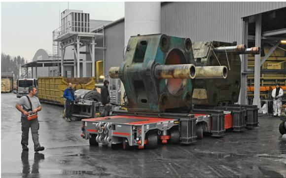
Le chariot automoteur commandé à distance est capable de déplacer des charges allant jusqu'à 175t.
