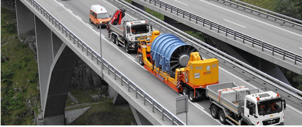
Les ventilateurs sont amenés à l'atelier et ramenés dans le tunnel sur une plateforme surbaissée.
