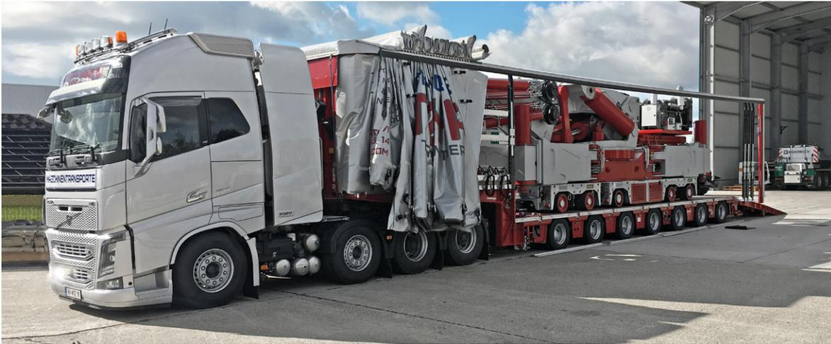
Le transport du Sefiro et de sa grue est assuré par des semi-remorques spécialement construits à cet effet.
