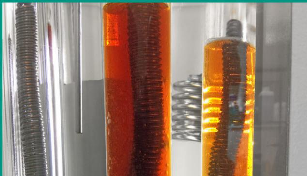
Der trockene (ohne Wasserzugabe) TOST verwendet eine Oxidationszelle aus Glas. Darin wird eine Probe des Testoels zusammen mit einem Katalysator platziert und auf 95 °C erhitzt. Der Probe wird zudem laufend Sauerstoff zugeführt. Das Resultat wird in Stunden angegeben und widerspiegelt die Oxidations-Lebensdauer des Oels bis zur definierten Versäuerung. ISO 4263-3/DIN 51554-3
