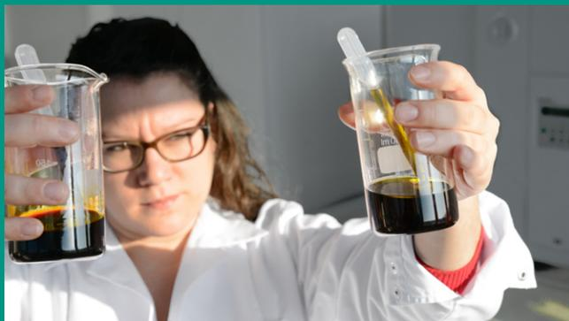
Je ein sauberer, polierter und exakt abgewogener Kupfer- und Stahlstab werden separat in ein mit dem Testoel befülltes Becherglas gestellt und in einem Ofen für 168 Stunden bei einer Testtemperatur von 135 °C erhitzt. Am Ende des Tests werden die beiden Stäbe visuell auf Verfärbung überprüft und gewogen. Beim Oel wird die gebildete Schlammmenge untersucht. ASTM D 2070
