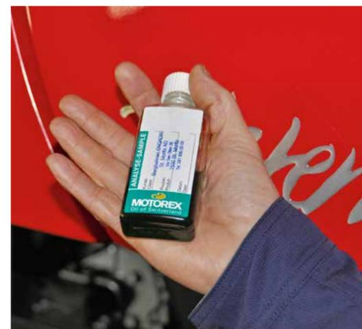
Impressionnant: Il suffit de 100 ml du fluide à contrôler pour que le laboratoire MOTOREX puisse faire les analyses requises.
