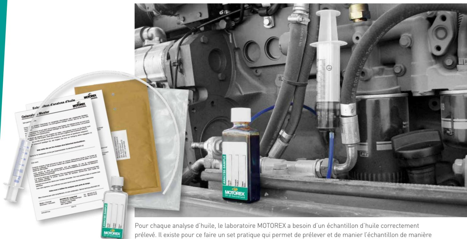
Pour chaque analyse d'huile, le laboratoire MOTOREX a besoin d'un échantillon d'huile correctement prélevé. Il existe pour ce faire un set pratique qui permet de prélever et de manier l'échantillon de manière simple et sûre à la fois.
