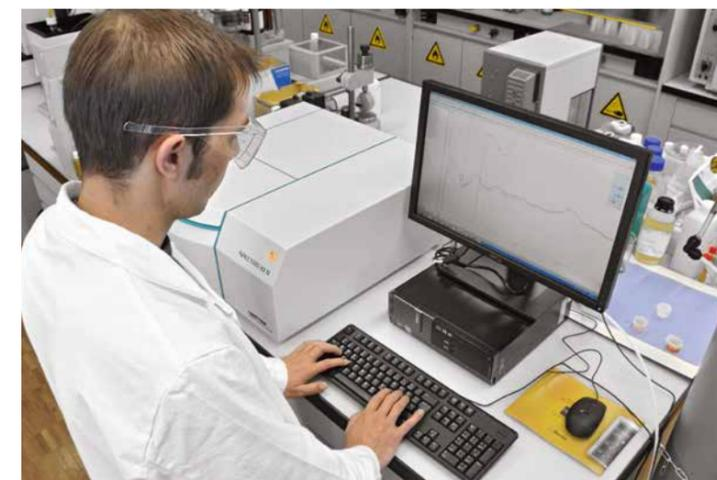
Différents échantillons, p. ex. d'un fluide hydraulique, peuvent être directement comparés les uns aux autres au moyen d'une spectrométrie de fluorescence X.
