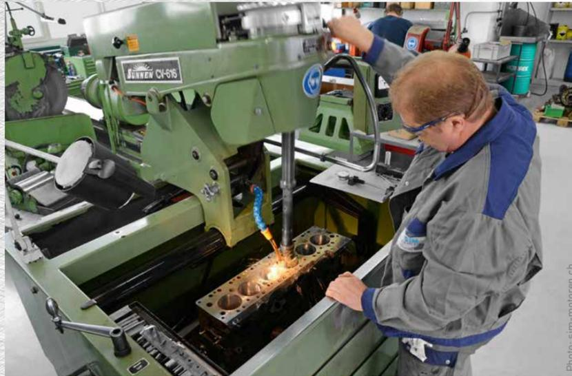
Il faut du savoir-faire: seul le honage correct permettra plus tard une interaction parfaite entre les segments de piston et le cylindre.
