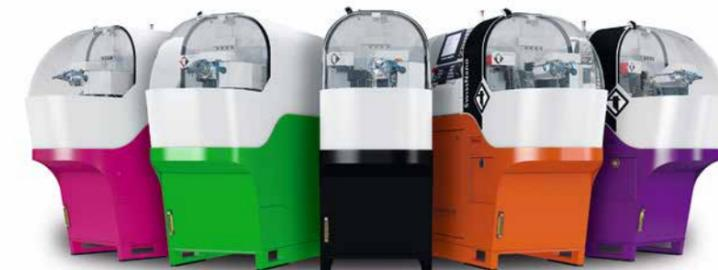
La SwissNano de Tornos a été mise au point pour le traitement de très petites pièces conforme aux exigences les plus strictes en matière de précision. Elle dispose de 6 axes linéaires et de 2 axes C, et convient à des diamètres de tige jusqu'à 4 mm.
