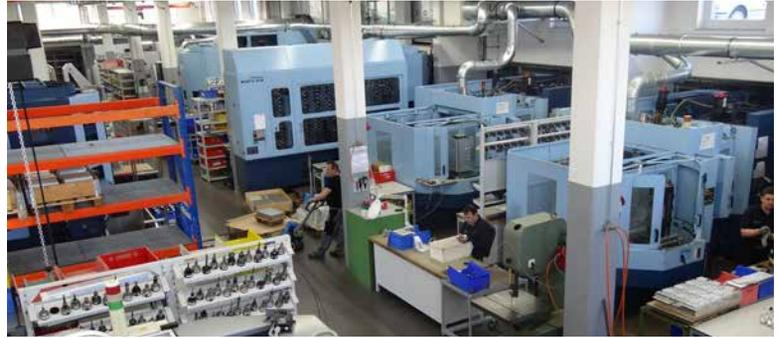
La halle des machines se trouve au sous-sol et dispose donc d'une température ambiante stable. Une condition idéale pour une précision optimale.
