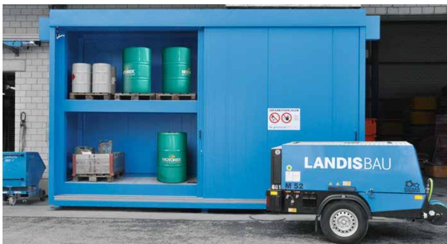
Exemple de centre d'entretien de Landis Bau AG, à Deinikon, dans le canton de Zoug: produits chimiques utilisés dans le bâtiment, carburants et lubrifiants sont triés selon divers critères et déposés dans des conteneurs coupe-feu.
