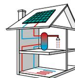
La restitution de la chaleur pour l'eau non potable ou de chauffage se fait via un échangeur thermique. Grâce à l'augmentation du volume due à la température, les installations solaires doivent toujours être équipées de récipients de compensation suffisamment bien dimensionnés. Les concentrations suivantes doivent être respectées selon les conditions d'utilisation: installations solaires (40-75%) et dans les autres installations (25-75%) de MOTOREX GLYTHERMIN P 44.
