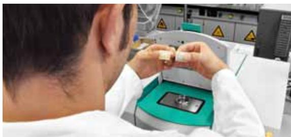
L'analyse de fluorescence X permet de comparer de manière concluante et fiable les deux échantillons de fluide hydraulique COREX HV.
