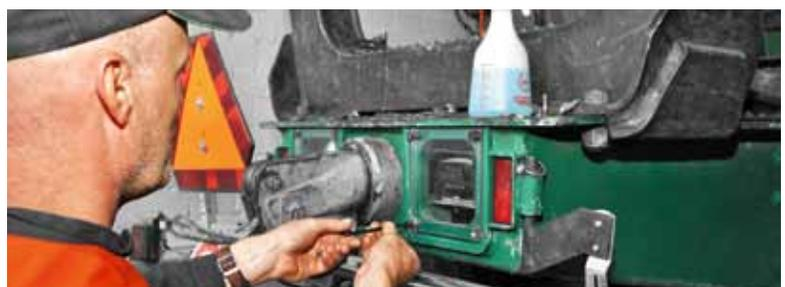
Nettoyage de la caméra de recul: un peu de lave-glace et quelques minutes de travail suffisent pour y voir clair derrière.
