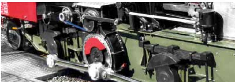
Bien en vue ici: le réservoir (sur photo en haut à droite) placé à proximité immédiate de la pompe de graissage.
