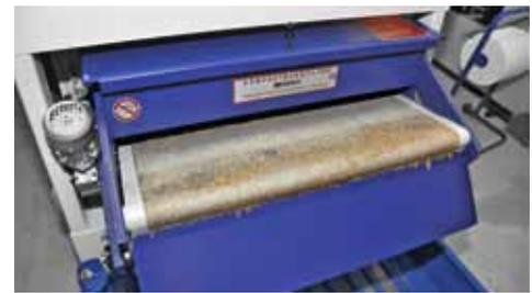
Pas moins de 1120 litres d'huile de coupe circulent dans la nouvelle MultiSwiss 6x14. La circulation de l'huile est complexe et fait appel à plusieurs filtres. De plus, toute la machine est régulée en température par un ensemble radiateur-échangeur thermique complexe.
