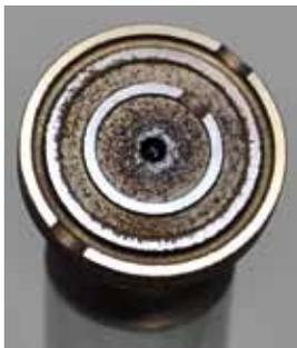
Cette pièce coulissante en laiton (une parmi d'autres) dans une pompe multipistons a été endommagée du fait d'une teneur en eau trop élevée dans l'huile hydraulique (cavitation).
