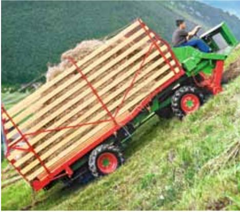
La récolte est ramassée par la chargeuse Schilter LT 2 avant l'essieu avant, d'où un avantage de taille pour la propreté du fourrage.
