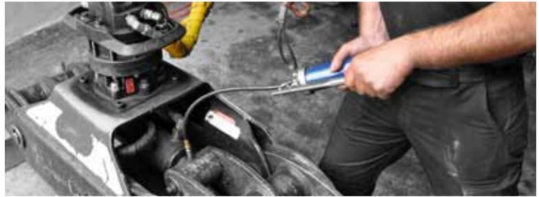
La tâche du conducteur de machine: la lubrification régulière, ici du grappin articulé d'une grue, avec le produit GRAISSE 190.
