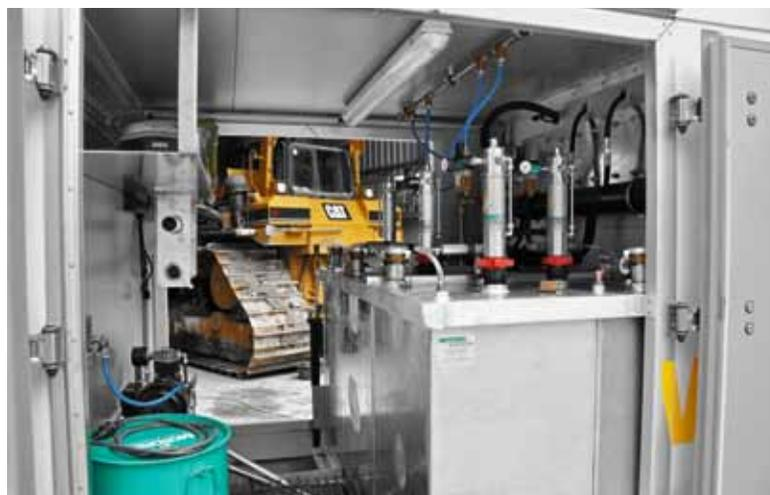
Ici, à l'œuvre, l'équipe de service Caterpillar en train d'aspirer vite et bien 150 litres d'huile d'engrenage pour la remplacer par du lubrifiant frais tout droit venu de la remorque d'huile.
