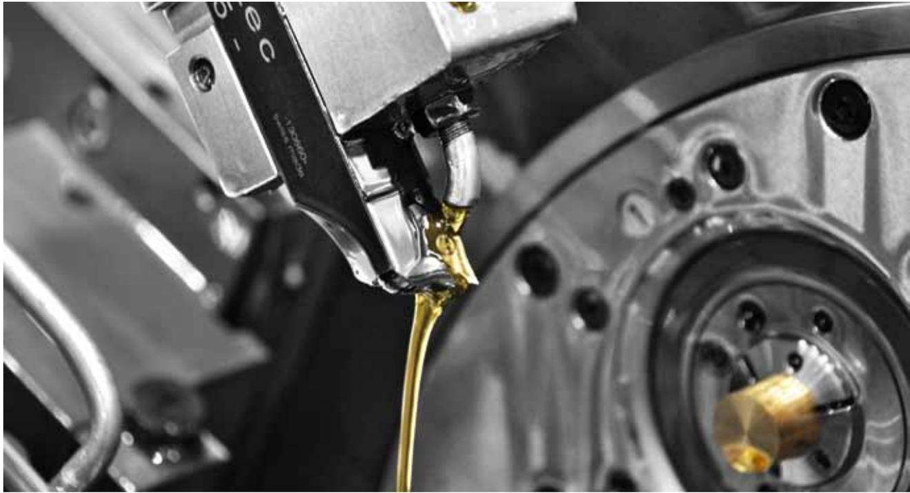
Le porte-outil de la Tornos MultiSwiss 6×14 comporte désormais un trou d'amenée du liquide de coupe qui est dirigé avec précision jusqu'au point le plus avancé: entre le tranchant de l'outil et la pièce à usiner.
