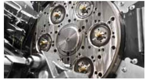
Le cœur de la machine: la zone d'usinage avec les six poupées mobiles. Grâce au concept multi-outil, il est possible de monter simultanément jusqu'à 18 outils différents sur la machine.
