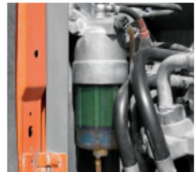
Il est très important de purger régulièrement l'eau de condensation déposée dans le filtre à carburant et dans le réservoir.
