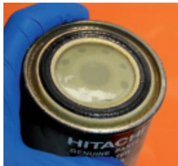
Une offensive de froid imprévue suffit pour que les cristaux de paraffine paralysent le système de carburant, p. ex. avec un filtre bouché.
