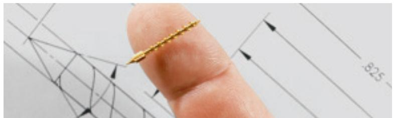
Mesurant 15 mm, cet axe de pulvérisateur de haute précision en laiton pour machine textile vient juste de succéder à une série de pièces en inox avec ORTHO NF-X sur une machine Tornos Deco 2000.
