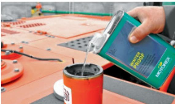
Toujours verser WINTER PROOF dans le réservoir avant de faire le plein et laisser tourner le moteur (5 min) pour s'assurer que la protection contre le froid est établie dans tout le système.
