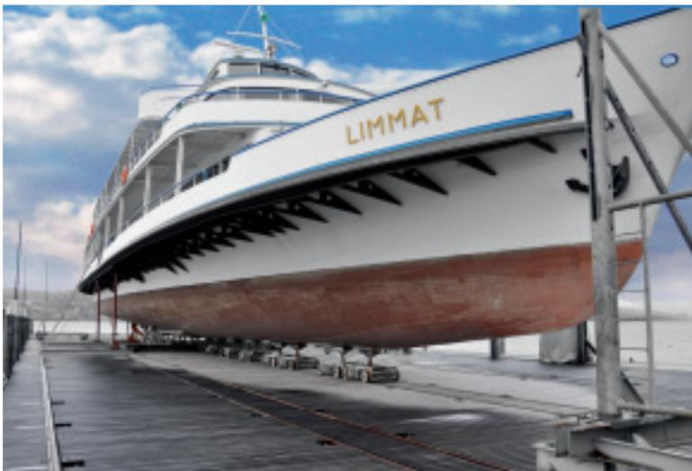
L'élévateur hydraulique de bateaux du Mythenquai à Zurich est capable de soulever 400 tonnes, de quoi sortir aisément de l'eau tous les bateaux et les acheminer vers le chantier si nécessaire.
