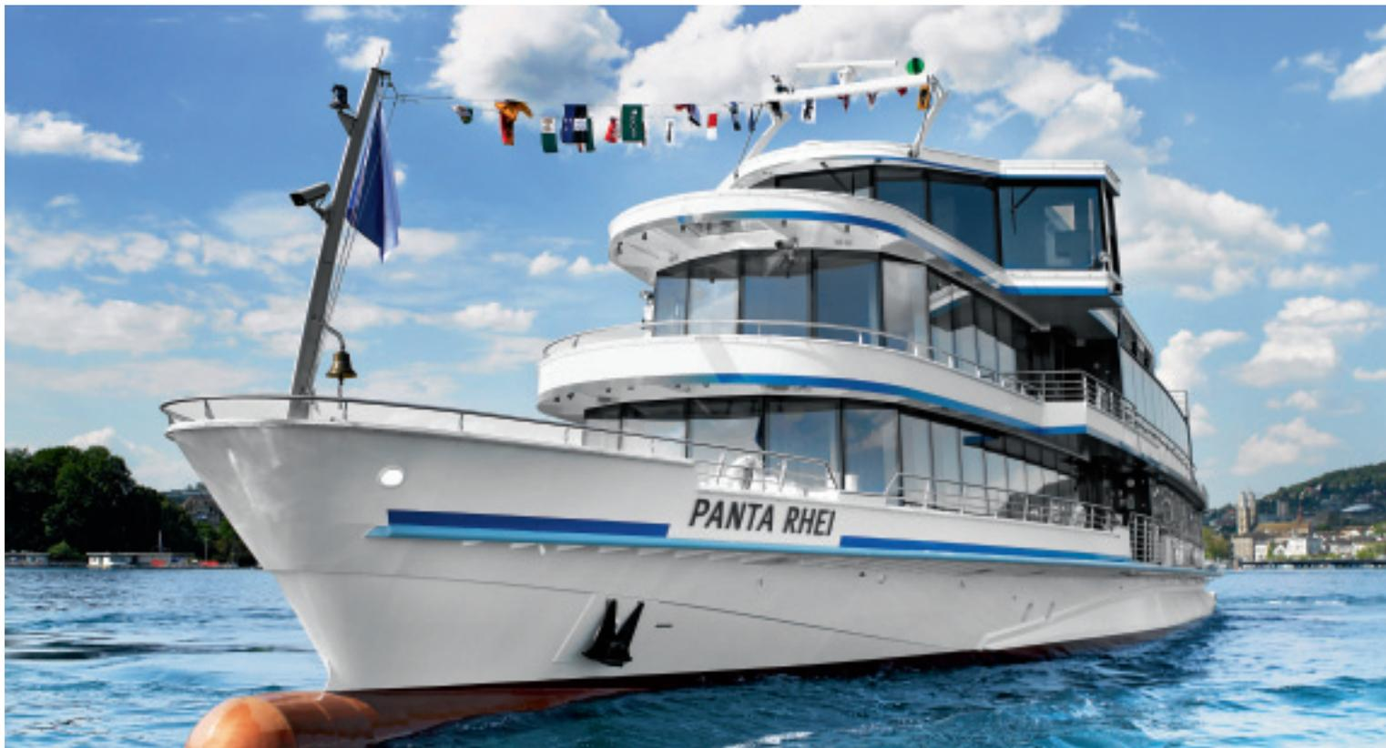
Le «Panta Rhei» est le plus jeune membre de la flotte zurichoise en tant que bateau à moteur dernier cri. Ses trois ponts peuvent accueillir confortablement 700 passagers. Long de 56 mètres et large de 11 mètres, ce bateau est propulsé par deux moteurs turbodiesel MAN de 600 CV.
