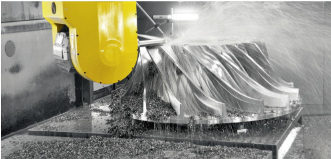
Construite comme exemplaire unique, une roue à aubes destinée à un compresseur utilisé notamment dans l'industrie de transformation du pétrole, s'est prêtée parfaitement pour un test de performance du nouveau lubrifiant réfrigérant MAGNUM PMC® 300.
