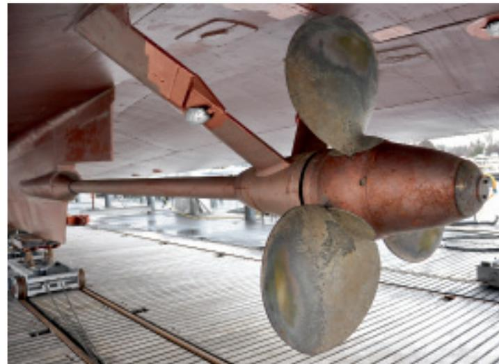
Le propulseur à hélice réglable par pression d'huile de la Fabrique de machines Escher-Wyss & Cie a révolutionné la navigation – pour sa part, MOTOREX fournit ici le lubrifiant approprié. On voit bien ici les deux anodes réactives métalliques en magnésium.
