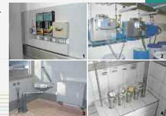
1) Le système de saisie des fluides MOTOREX LÜMATIC. 2) Systèmes mélangeurs automatiques. 3) Station d'élimination vers les réservoirs centralisés. 4) Tubulures de remplissage et d'aspiration.
