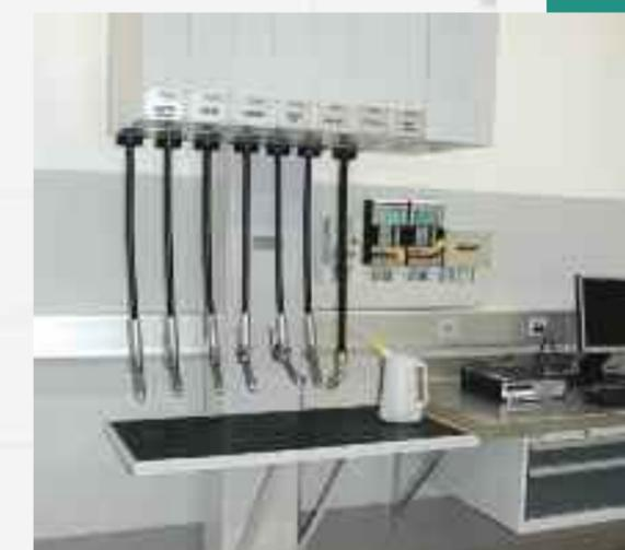
Tous les fluides nécessaires sont remplis directement dans les moteurs au moyen de distributeurs avec enrouleurs de tuyaux.
