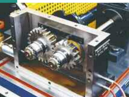
Dans le test FZG de gauchissement des engrenages, une paire d'engrenages fonctionne dans le bain d'huile.
