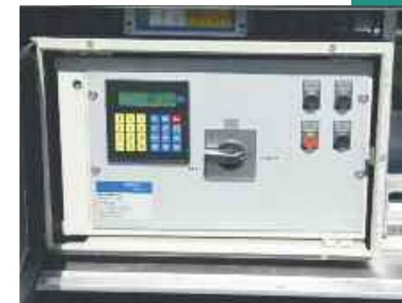
Un compteur étalonné permet de saisir la quantité exacte livrée et d'imprimer un bulletin de livraison à bord même du camion.
