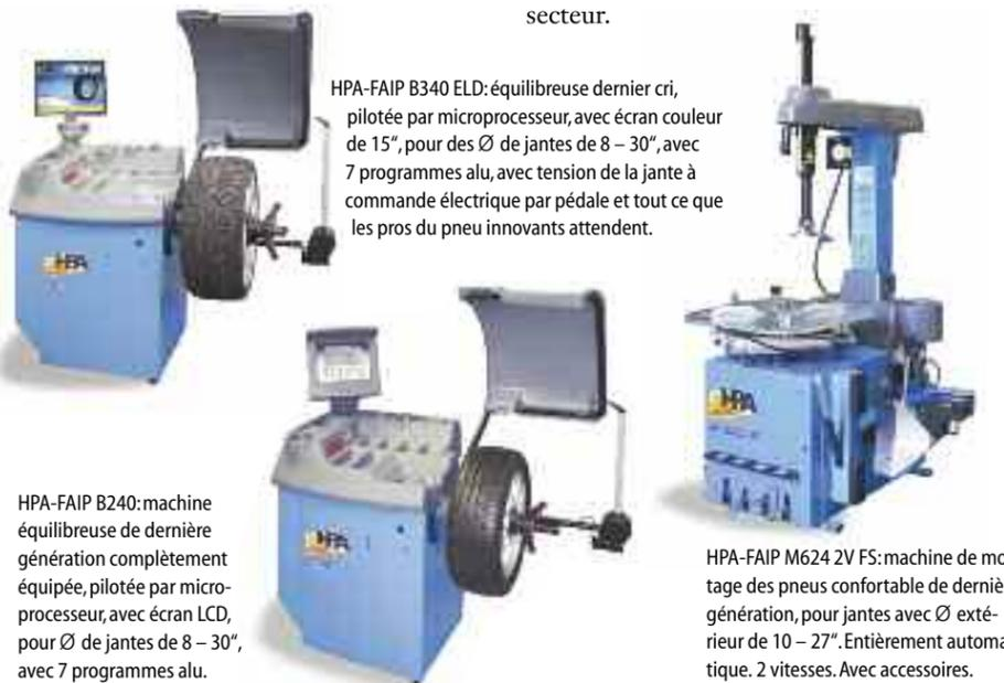
HPA-FAIP B240: machine équilibruse de dernière génération complètement équipée, pilotée par microprocesseur, avec écran LCD, pour Ø de jantes de 8 – 30", avec 7 programmes alu.
