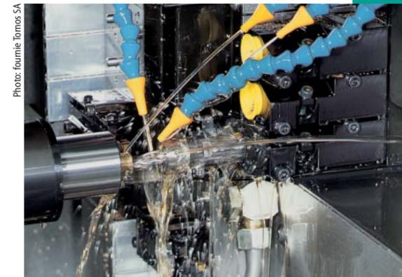
Lors de l'usinage, les pièces en métal non ferreux s'échauffent moins que celles en acier – ORTHO NF-X est efficace dans tous les cas.
