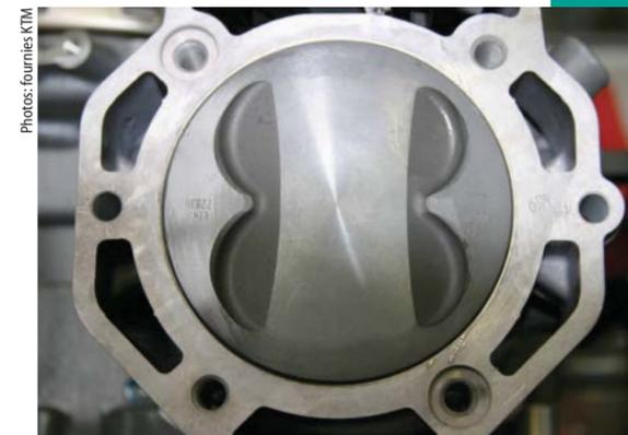
Juste 0,04 mm de jeu de montage entre le piston, dont la course est de 36,7 mètres par seconde, et la chemise du cylindre.
