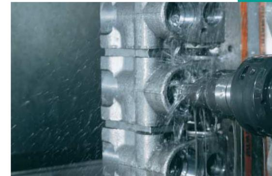
Das Schneidöl SWISSCUT TWIN 300 und das eingesetzte MAPAL-Werkzeug optimieren spürbar das Bearbeitungsresultat.
