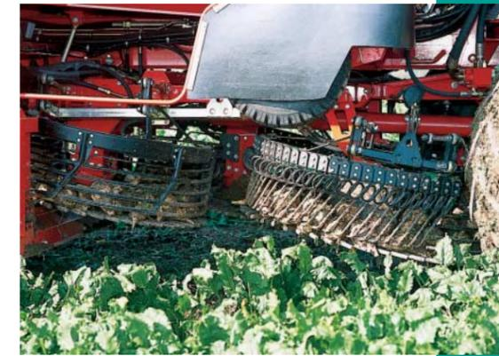
Ein langer Reinigungsweg von ca. 11 Metern ist die Voraussetzung für eine optimale und schonende Reinigung der Rüben.
