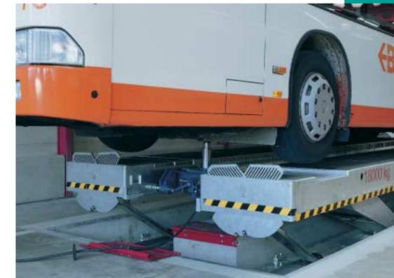
Die Fahrschienen sind mit einer Aussparung für die Lenkgeometriedrehplatten und einem verschiebbaren Kurzheber ausgerüstet.
