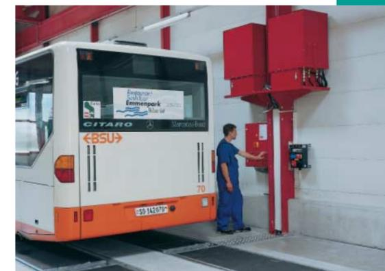
Die Bedien- und hydraulische Antriebseinheit konnten platzsparend seitlich der Hebebühnen angeordnet werden.
