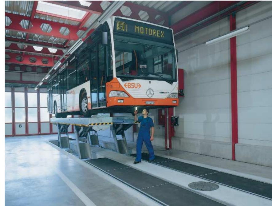
Bis zu 16 Meter lange Gelenkbusse oder ganze 36 Tonnen heben? Seit kurzem Realität in der BSU-Werkstätte der Busbetriebe Solothurn und Umgebung.
