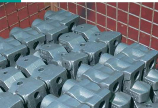
Gleich gitterweise treffen die Hydraulikblock-Rohlinge aus der Giesserei zur Bearbeitung in Frutigen ein.
