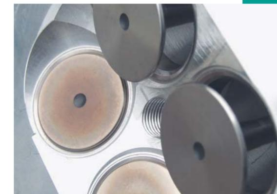
Bei Motoren, welche mit verbleitem Benzin betrieben werden mussten, ersetzt VALVE GUARD die schmierende Wirkung des Bleis.
