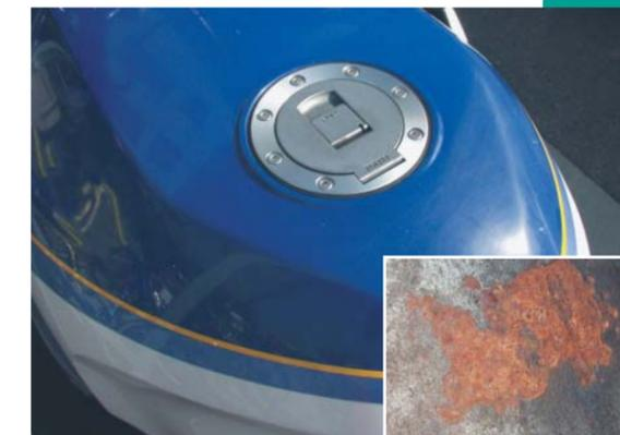
Moderne Tanks sind innen oft beschichtet. Ältere Tanks können in Verbindung mit H<sub>2</sub>O und Sauerstoff rosten.
