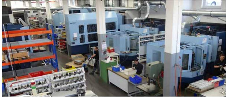
Die Maschinenhalle befindet sich im kühlen Untergeschoss und verfügt so auf natürliche Weise über eine stabile Grundtemperatur. Eine ideale Voraussetzung für höchste Präzision.
