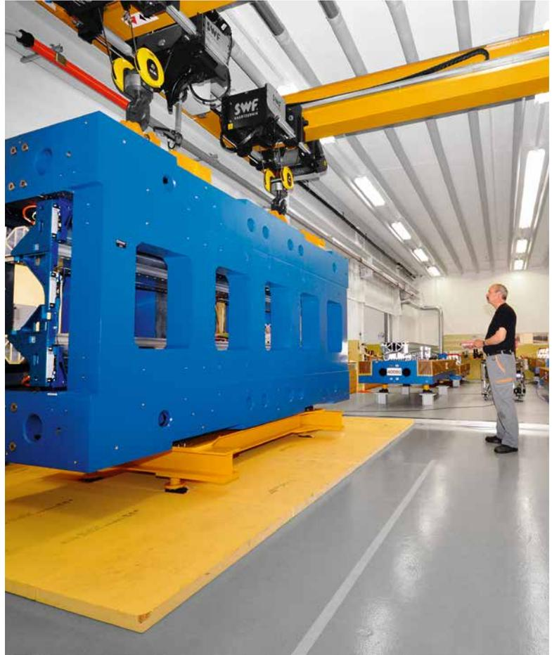
Die präzise klimatisierte Montageabteilung bei der Max Daetwyler AG in Ursenbach wurde spezifisch für den Zusammenbau der Undulatoren ausgelegt und bietet Platz für mehrere Anlagen.
