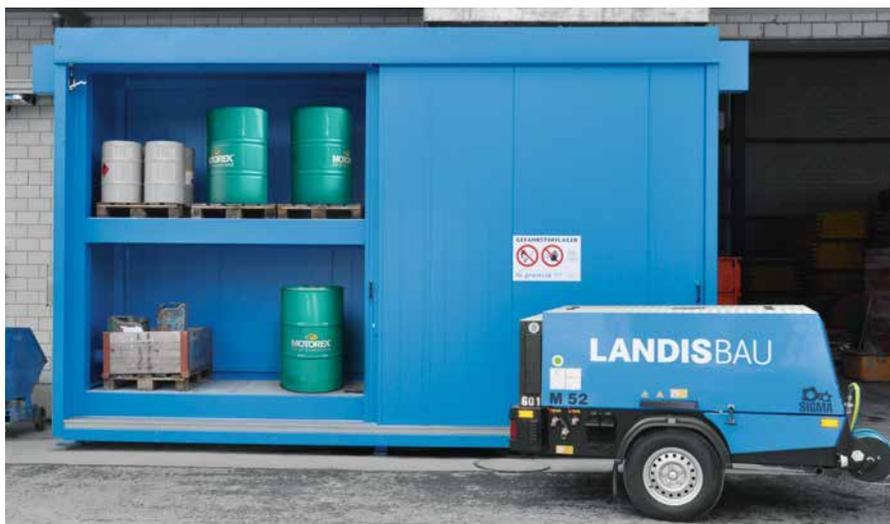
Beispiel Werkhof der Landis Bau AG in Deinikon im Kanton Zug: Bauchemie, Kraftstoffe und Schmiermittel sind nach verschiedenen Kriterien getrennt im Brandschutzcontainer untergebracht.
