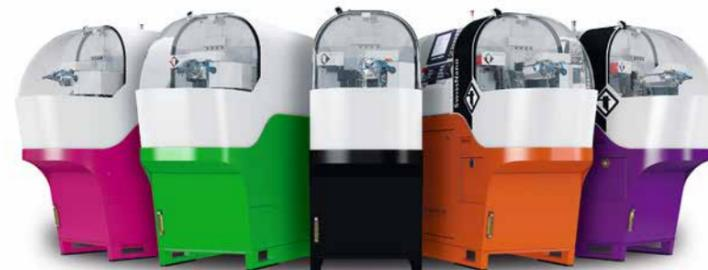
Die SwissNano von Tornos wurde für die Bearbeitung sehr kleiner Teile mit höchsten Präzisionsanforderungen entwickelt. Sie verfügt über 6 Linear- und 2 C-Achsen und eignet sich für Stangendurchmesser bis zu 4 mm.
