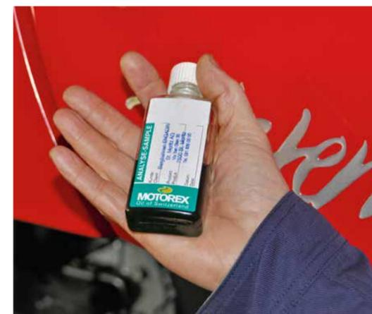
Aussagekräftig: Bereits 100 ml des zu überprüfenden Fluids reichen dem MOTOREX-Labor, um die gewünschten Analysen durchzuführen.
