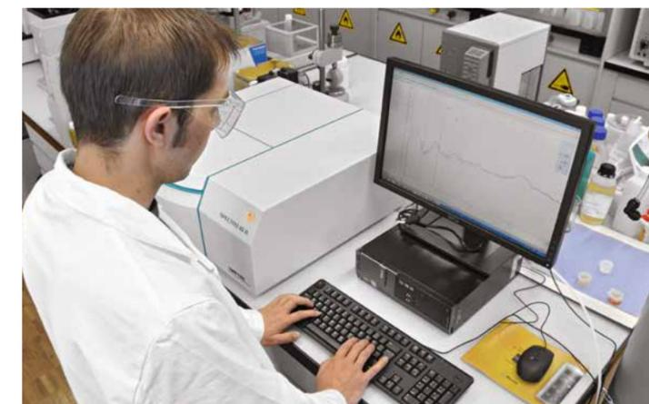
Verschiedene Muster, z. B. eines Hydraulikfluids, lassen sich durch die Röntgenfluoreszenzanalyse direkt miteinander vergleichen.
