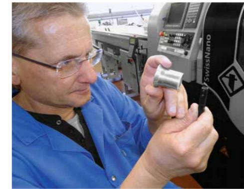
Der Verschleiss und die Farbe der eingesetzten Werkzeuge sind für den Décolleteur stets sehr aufschlussreich.
