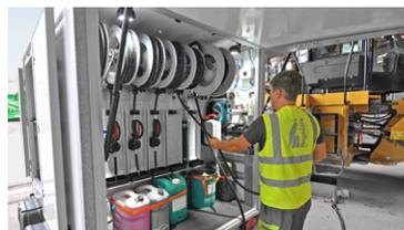
Hier wird bei einem Radlader das Motorenoel gewechselt. Ersetzt wird es durch frischen Schmierstoff aus dem Oelserviceanhänger.
