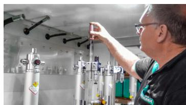
Einstellen des Druckluftöleblers bei der Montage des Oelserviceanhängers im Werk bei MOTOREX.
