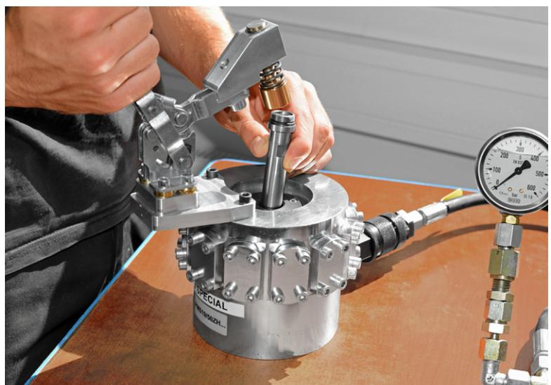
Feste Verbindung: Hydraulisches «Crimpen» des Ankerrohrs in der Serienfertigung mit einer bauähnlichen Crimpmaschine.
