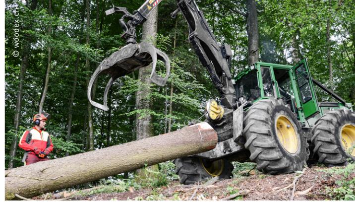
Effizient: Das «Rücken» wird fernbedient von einer Person durchgeführt und das Zugseil lässt sich per Funk entriegeln.
